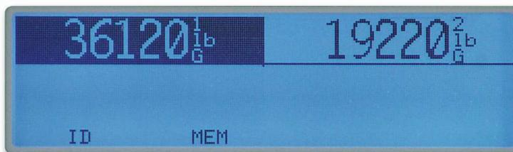
Utilice las teclas de navegación del 225 para alternar rápidamente entre las escalas.
